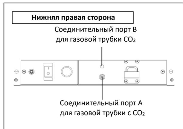
4. После подключения газовой трубки убедитесь, что нет утечки газа (например, с помощью распылителя для обнаружения утечки газа).
