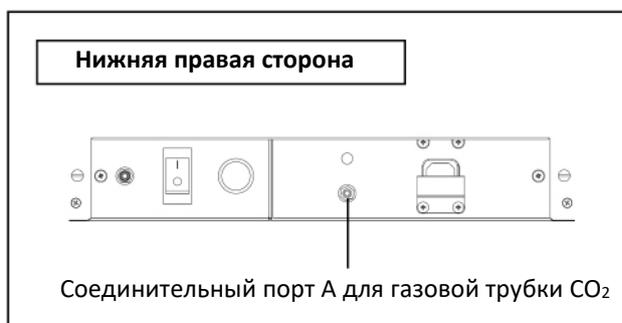
3. После подключения газовой трубки убедитесь, что нет утечки газа (например, с помощью спрея для обнаружения утечки газа).
