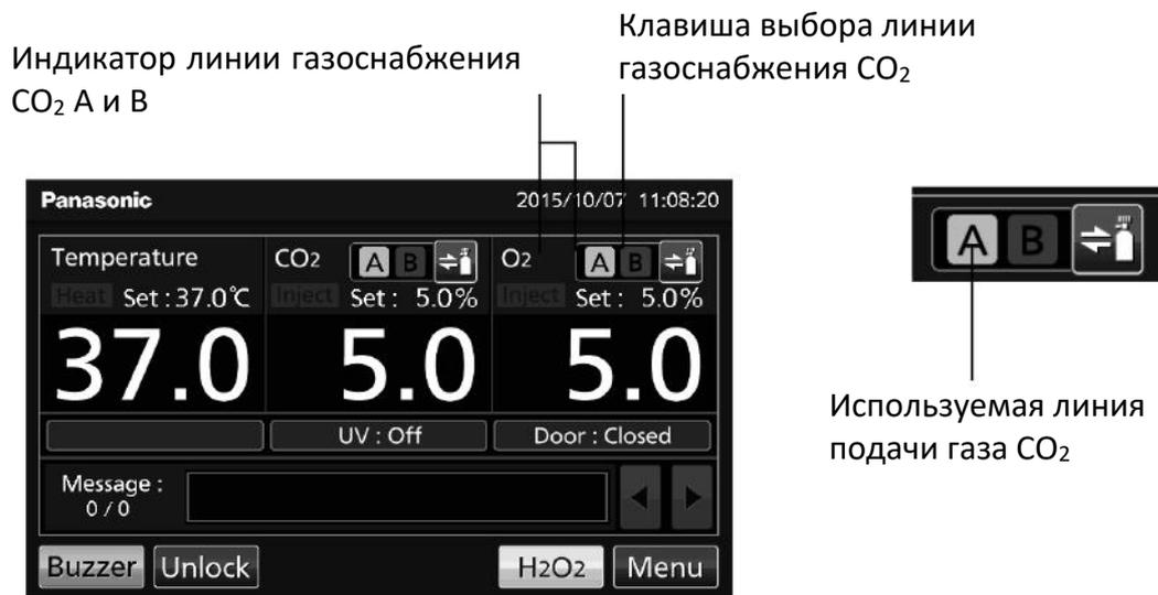
Когда уровень концентрации CO<sub>2</sub> остается неизменным, даже при том, что газовый клапан CO<sub>2</sub> в устройстве открыт, устройство определяет подключенный баллон с CO<sub>2</sub> как пустой. Линия газоснабжения CO<sub>2</sub> переключается автоматически. Эти изменения отображаются (Табл. 4).
