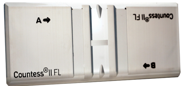
Рис. 2. Варианты слайдов для многократного применения для автоматического счетчика клеток Countess® II FL.
