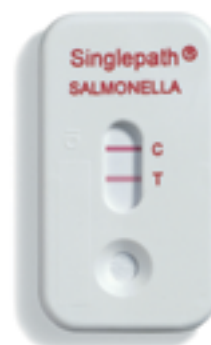
Рис. 2: Положительный тест Singlepath® на Salmonella – красная линия в зоне Т с внутренним контролем (красная линия на С)
