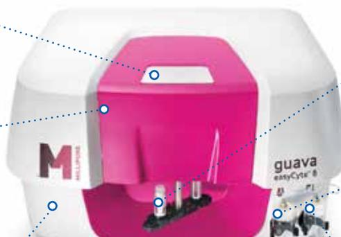
Устройство загрузки одного образца, функционирует как поворотный кронштейн, с держателем двух пробирок, позволяющий мгновенно загружать исследуемый образец
