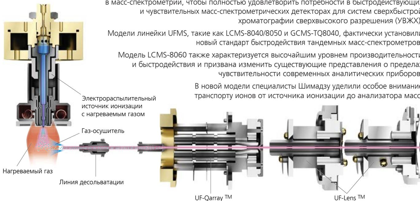
Инновационная система ионной оптики UF-Qarray фокусирует поток ионов и в сочетании с источником ионизации с нагреваемым газом и усовершенствованной системой вакуумирования обеспечивает значительное усиление интенсивности сигналов целевых ионов. При этом интенсивность шума не возрастает и остается на уровне, характерном для предыдущих моделей масс-спектрометров.
