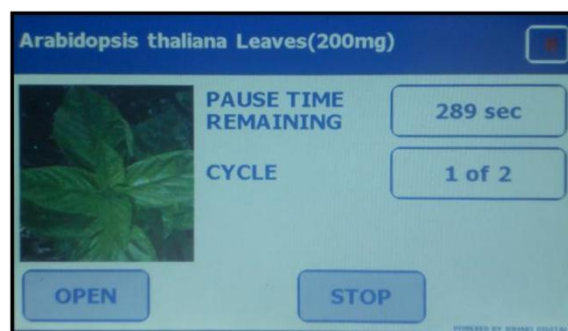
Рисунок V-7: Отображение обратного отсчета времени паузы между циклами на сенсорном экране FastPrep-24 5G
