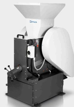
Щёковая дробилка ВВ 300 используется для **быстрого бережного предварительного измельчения средне-твердых, твердых, хрупких и прочных материалов**. Благодаря своей **эффективности и безопасности**, а также **большому выбору материалов размольной гарнитуры**, включая сталь без примеси тяжелых металлов, ВВ 300 идеально подходит для подготовки проб в лаборатории и на производстве.
