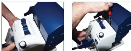
**Рис. 6** Слегка нажмите на головку и поверните винт до нижнего упора
