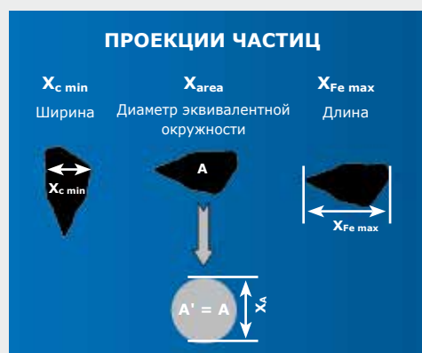
Примеры параметров размера при анализе изображений отдельных частиц, полученных с камер высокого разрешения анализатора CAMSIZER X2
