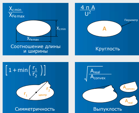
Помимо определения различных параметров размера также определяются параметры формы частиц, которые являются важными показателями качества продукции. На рисунке выше изображены наиболее важные из этих параметров.
