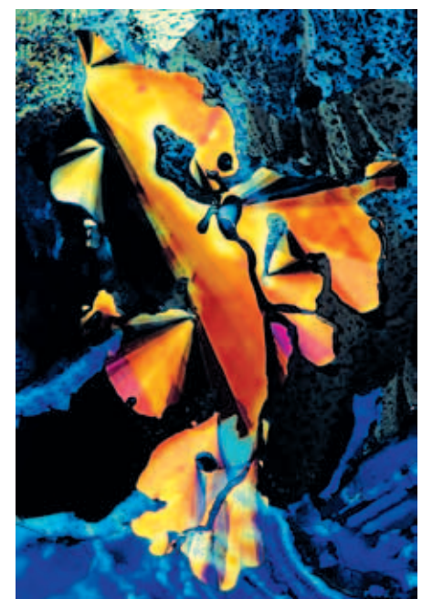
Рис. 37. Поляризационная микроскопия проходящего света; изменение вида расплавленных химических веществ при просмотре через скрещенные поляризаторы. Снимки любезно предоставил Норберт Юнкер, Olympus Europa GmbH, г. Гамбург, Германия.
