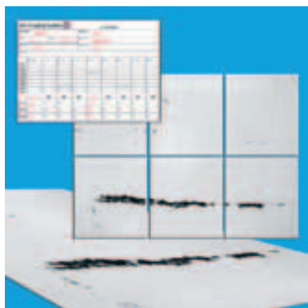
Рис. 21: Анализ неметаллических включений согласно DIN, ASTM и JIS требует обработки образца площадью до 1000 мм 2 , в то время как сульфидные и оксидные включения, подлежащие анализу, сами не шире микрометра. Цифровой камеры с таким большим ПЗС-сенсором не существует. Проблема обработки изображения решается методом сшивания отдельных перекрывающихся друг друга изображений и получения одного изображения с высоким разрешением.
