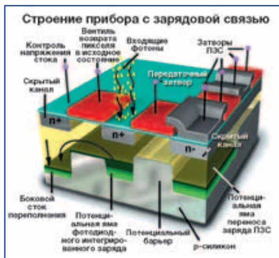
Рис. 7. Принцип действия цифровых камер ПЗС.
