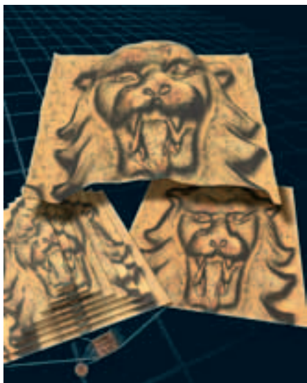
Рис. 25: На этом рисунке показано, что можно сделать с изображением монеты. Деталь сингапурской монеты была снята цифровым ПЗС-фотоаппаратом «ColorView» и обработана с помощью выравнивания, расширенного фокуса и программных модулей трехмерных измерений. Снимите и автоматически выровняйте многочисленные компоненты изображения в единое изображение с высоким разрешением, используя модуль MIA. Извлеките самые резкие детали в компонентах изображения и соберите их в единое изображение с бесконечной глубиной фокуса, используя модуль EFI. Наконец, создайте невероятно реалистичные виды, используя информацию о высоте и фактуре, полученную с помощью функций перспективы модуля 3D.
