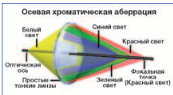
Рис. 6: Схематическое изображение осевой хроматической aberrации.
