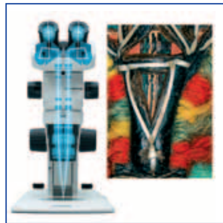
Рис. 54: Световой путь в стереомикроскопе (с промежуточной системой Галилея) – два микроскопа в одном – обеспечивает изучение образцов под естественным углом схождения глаз человека. Это позволяет наблюдать трёхмерный рельеф поверхности. Однако, при получении изображения снимок всё же остаётся двухмерным.
